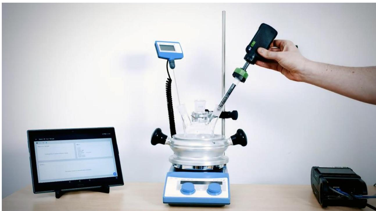
Leyenda: La tecnología deepmatter® SmartChemistry® usada con plataforma térmica sin aceite DrySyn y kit de placa térmica Asynt.
