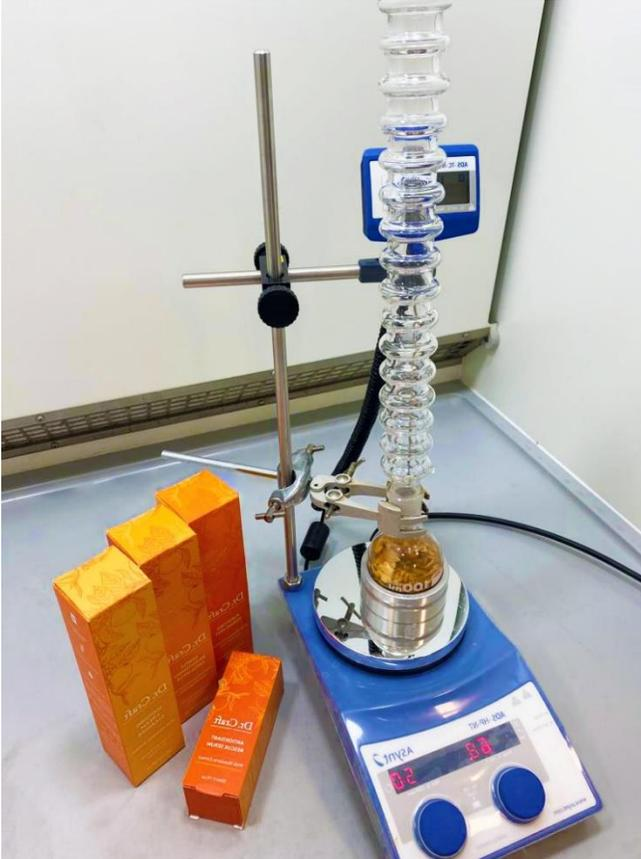
Leyenda: Extracción sostenible de la cáscara de mandarina usando el bloque térmico DrySyn y el condensador sin agua Maxi Condens
