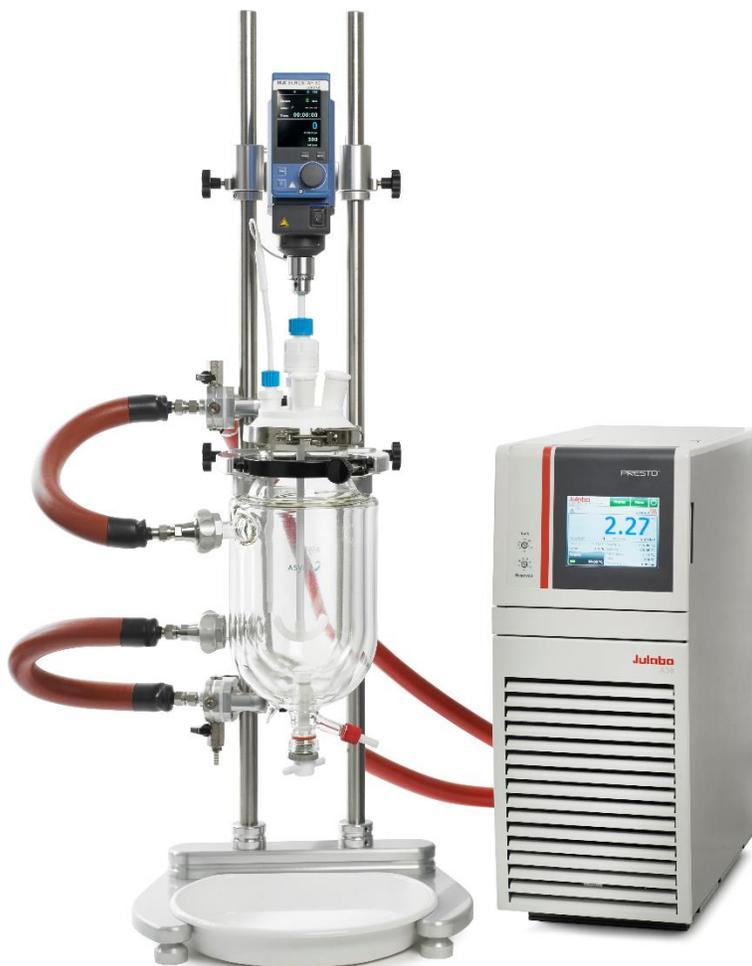
Légende : Le ReactoMate DATUM avec le régulateur de température Julabo
