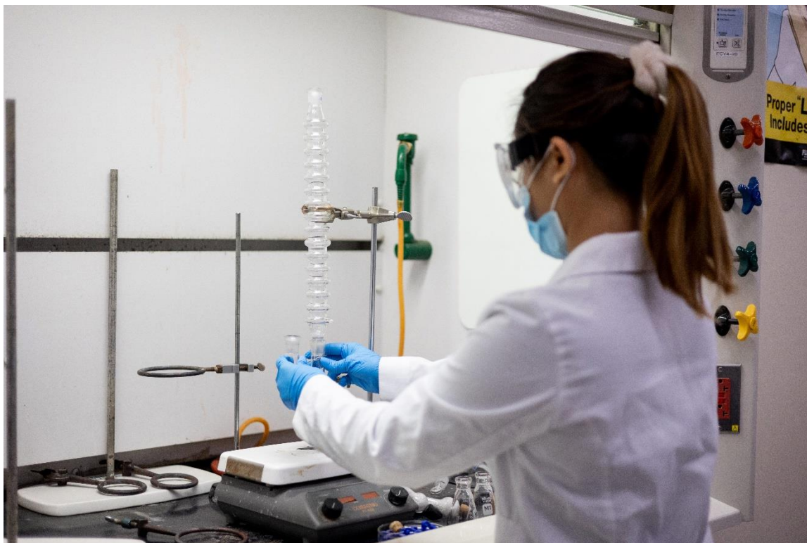
Leyenda: Margarete Teo, una estudiante de los laboratorios de docencia en el College of the Sequoias (Visalia, CA) usando el condensador sin agua CondenSyn
