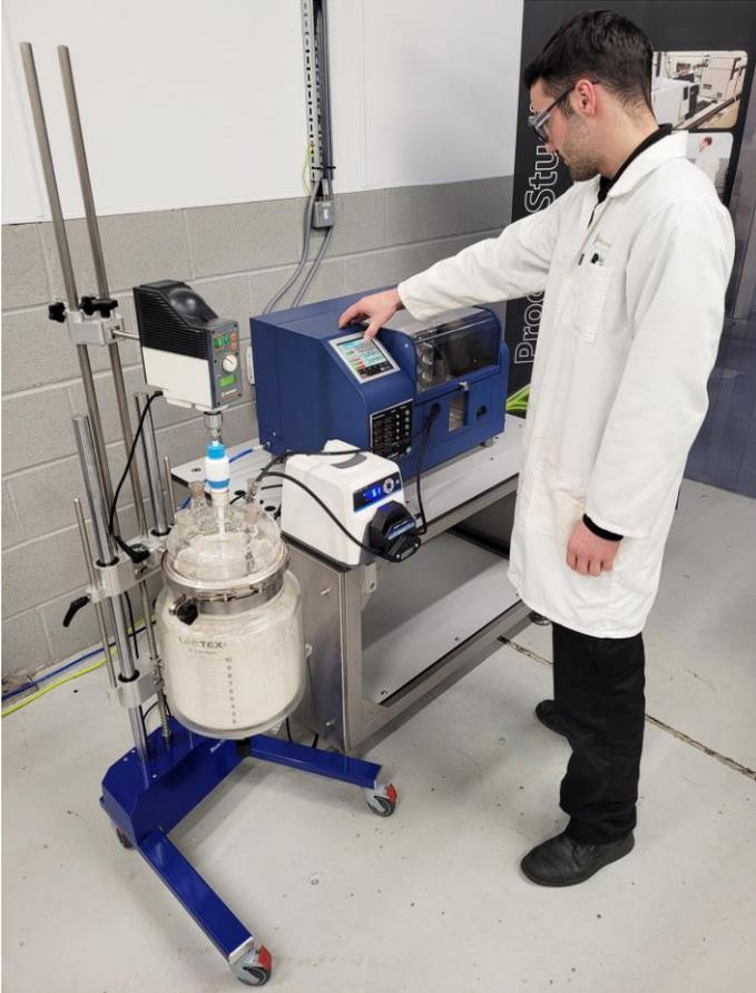
Bildunterschrift: AMT Reinraumbetrieb mit einem Coflore® Flow-Reaktor, der über einen effizient gerührten Behälter in einem ReactoMate ATOM Ständer versorgt wird.
