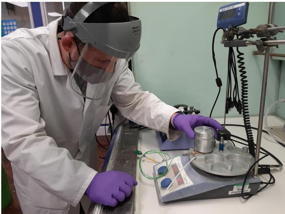
Leyenda: Harrison Johnson-Evans del iRPD configurando el sistema fotoquímico de flujo del fReactor
