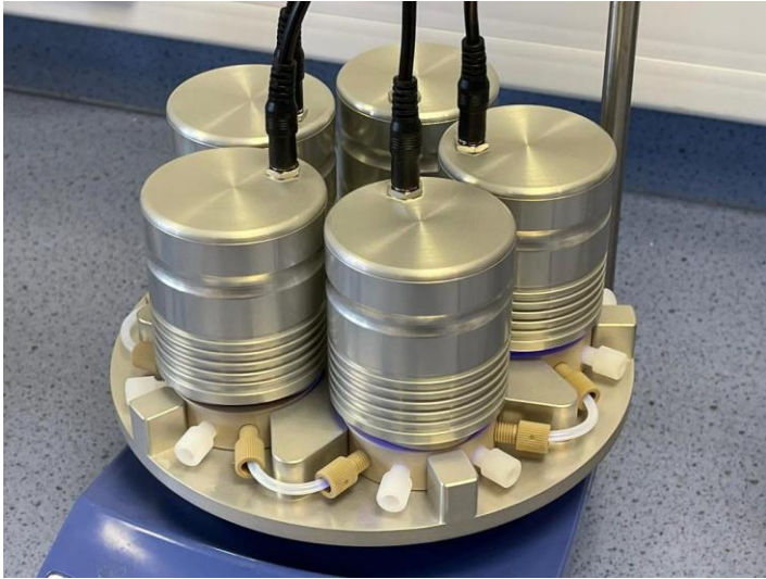
Bildunterschrift: Ein Asynt fReactor Photo Flow mit 5 Moduln auf einem Magnetrührer
