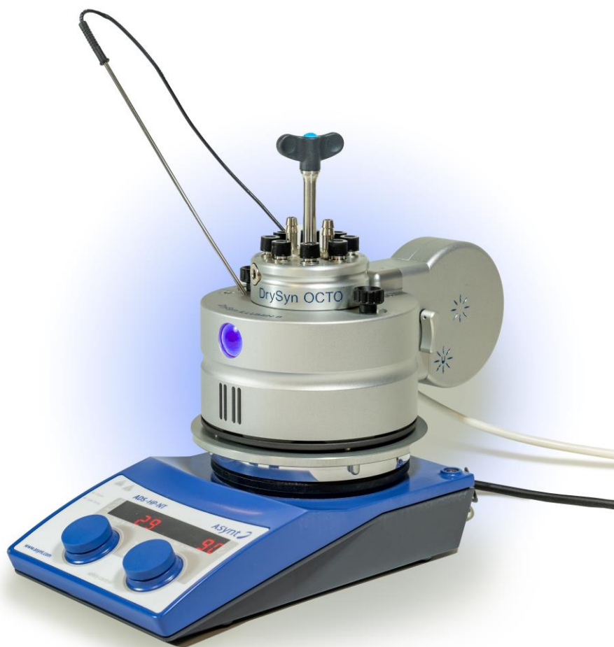
Légende : photo-réacteur parallèle Illumin8
