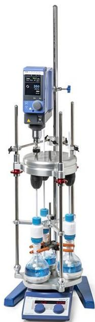
Leyenda: Agitador suspendido DrySyn Vortex con placa térmica que realiza 3 reacciones en paralelo
