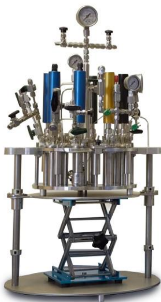
Bildunterschrift: Multicell PLUS und Detailaufnahme von bedienerfreundlichem Stützrahmen / Hubplattform
