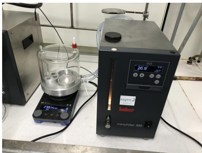
Leyenda: Reactor DrySyn SnowStorm con enfriador termostático externo y calentador / agitador
