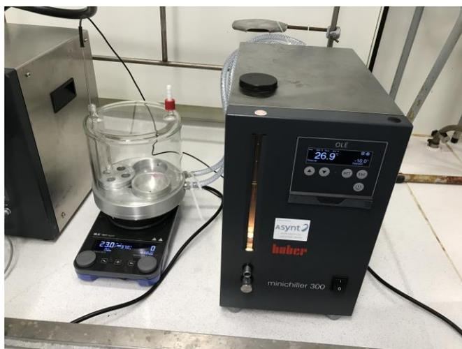
Légende : Réacteur DrySyn SnowStorm avec refroidisseur/réchauffeur/agitateur thermostatique externe
