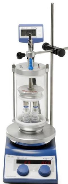
Leyenda: El evaporador espiral DrySyn de Asynt permite a los usuarios poner al vacío hasta cuatro muestras distintas a la vez, racionalizando los procedimientos de elaboración para múltiples reacciones.
