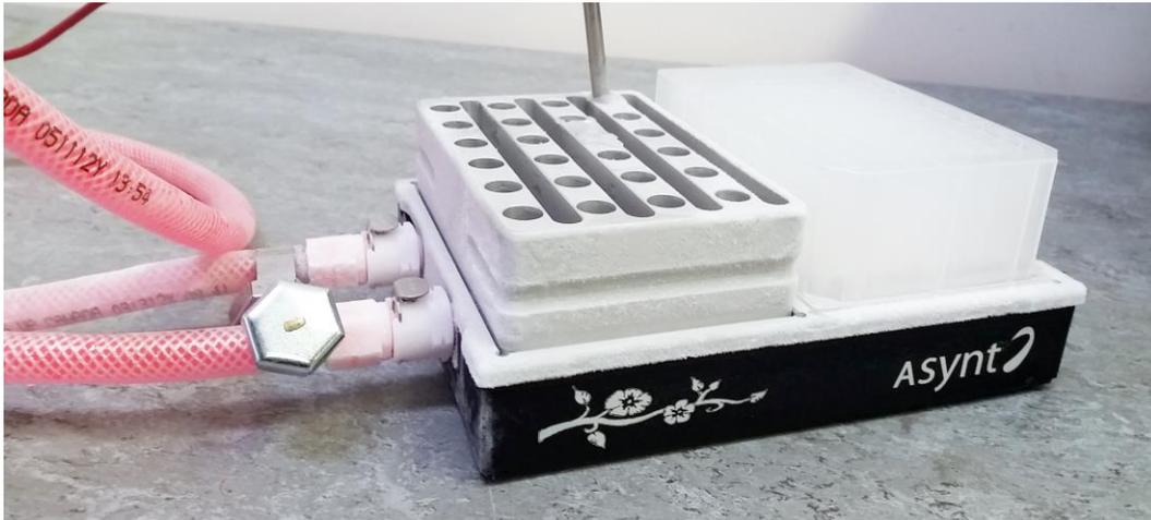
Leyenda: Instalación Chilliblock para la refrigeración de tubos y una microplaca
