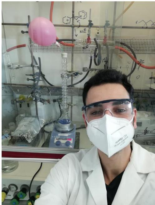
Bildunterschrift: Ein Forscher der Maulide Group mit deren DrySyn MULTI / CondensSyn 'Green' Rückfluss-Aufbau
