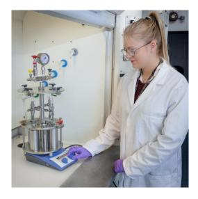
Bildunterschrift: Kundenspezifischer Hochdruck-Parallelreaktor
