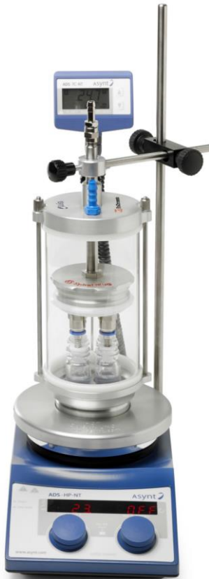
Bildunterschrift: DrySyn Spiral Evaporator auf einem Asynt Heizplattenrührer
